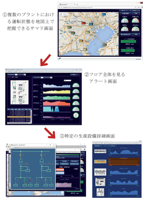
図2 シンクライアントで運用されるRTView設備監視ダッシュボード
