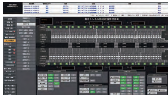
(事例より) トンネルにおける防災設備監視画面例 この1画面のみで、非常電話、スプリンクラー、消火栓など、それぞれ何十もの機器グラフィック・オブジェクトで構成されています。
