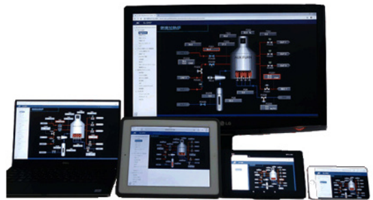
写真1 コンパクトで高速なHTML5に変換されてWeb運用される「SL-GMS」
